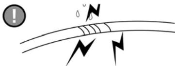
El presurizador no debe funcionar más de cinco minutos con la válvula de salida cerrada, porque el funcionamiento prolongado sin cambiar el caudal hará que la temperatura y la presión del líquido aumenten en el cuerpo del presurizador.
