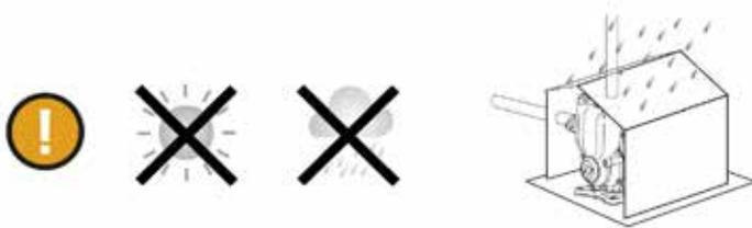
Al tomar medidas para anticongelar el presurizador de agua en invierno, no cubra el motor o la bomba con materiales combustibles para el anticongelante, ya que esto provocará poca ventilación y disipación de calor, lo que provocará fácilmente un incendio.
